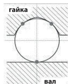
Рис. Работа беспрофильной шарико-винтовой пары
